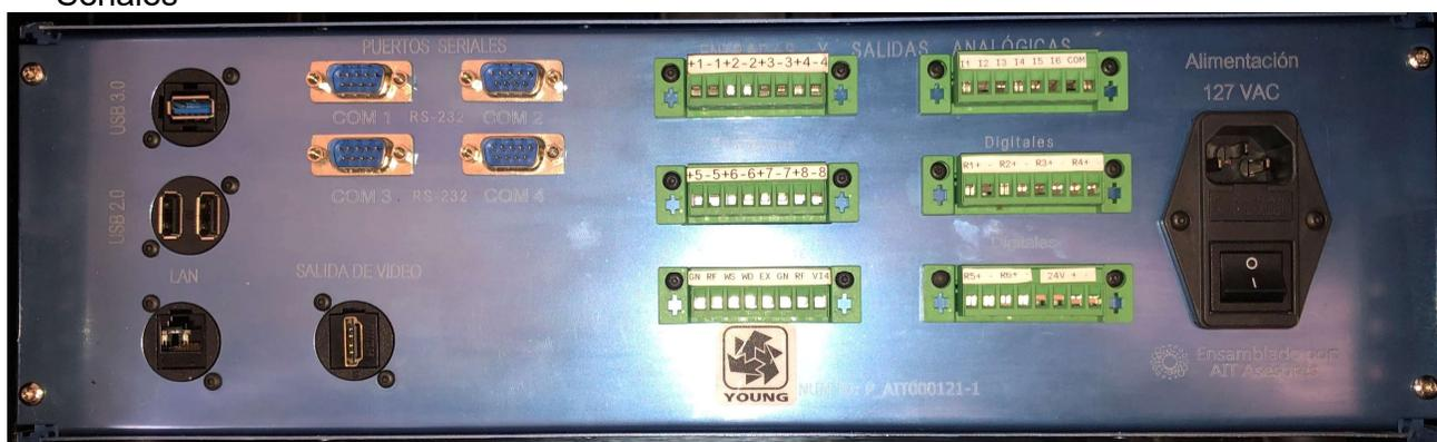
Módulos de conexión para 8 entradas analógicas, 6 entradas Digitales, 6 salidas digitales, entradas para señales directas de sensores de VV, DV, así como sensores analógicos y salida de 24VCD para alimentación de sensores.
